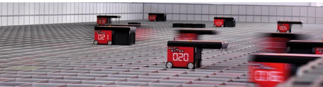
**33 robot**, in maniera totalmente automatizzata, prelevano gli articoli necessari a comporre ciascun ordine.
