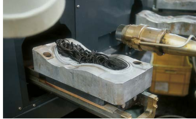
Produzione di soles in gomma Production of rubber soles Produktion der Gummisohle
