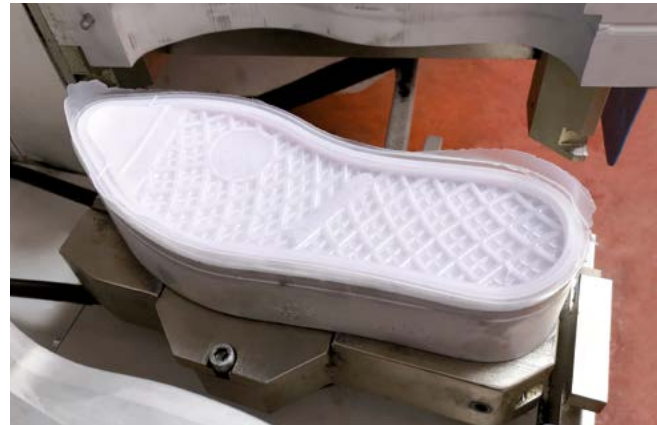
Produzione di soles in TPU Production of TPU soles Produktion der TPU Sohle
