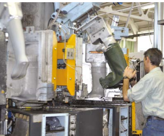
Produzione di stivali in poliuretano Production of polyurethane boots Produktion der PU-Stiefel
