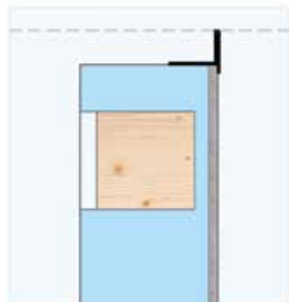
B Standard: Profilo parasigolo in pvc con retina. Idoneo per finitura muraria con intonaco esterno (con spessore di 15 mm).
