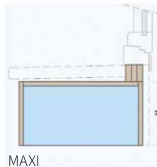
C Sottobancale Maxi per porta-finestra con funzione di fermagetto. Costituito da base in xps rivestito in duripanel e listello sotto-serramento.
