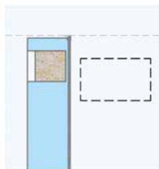
B Posizionamento dei fori sul pannello del soprabancale per il montaggio delle scatole (fornite dal cliente).
