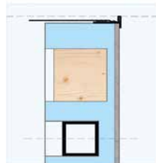
D Tubolare in acciaio (40x40 mm) con relative zanche a murare, integrato su spalle termiche. Funzionale al fissaggio di inferriate e/o parapetti.
