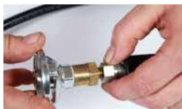
Collegare l'adattatore per la pulizia al tubo e serrare con una chiave fino a chiusura avvenuta
