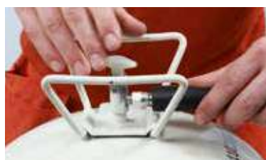
Collegare nuovamente il tubo alla bombola
