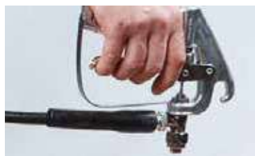
Liberare completamente il tubo dai residui di adesivo
